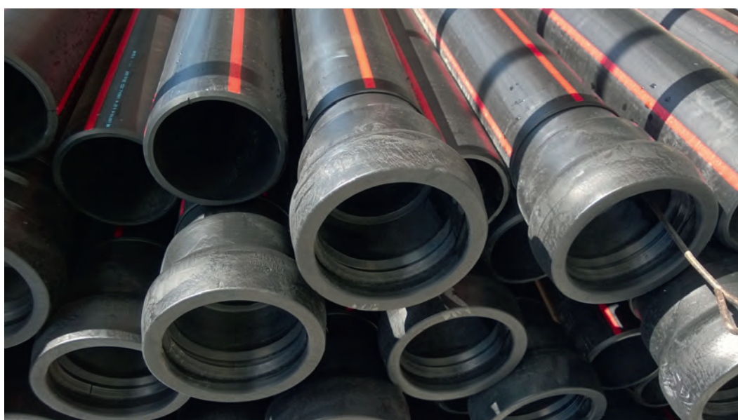
Barre équipée de manchons mécaniques soudés en usine
